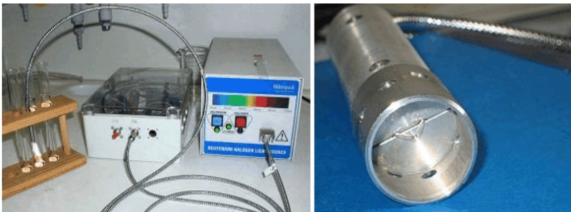
Abb. 13: Faseroptisches Fluorometer (links: Lampe und Detektor, rechts: Faserkopf)
