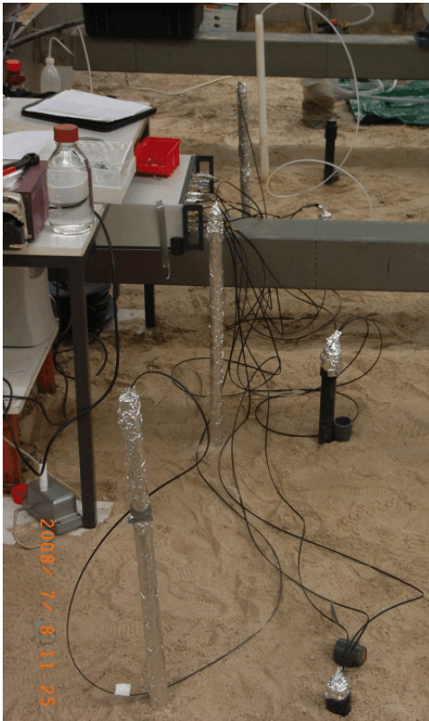
Abb. 65: 1-Zoll- und CMT-Messtellen mit Lichtleitern zur Uraninmessung
