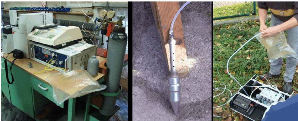
Abb. 27: Feldlabor mit Headspace-CG/PID (li), Rammspitze für die Bodenluft-Probennahme (Mitte) und MOX-System mit angeschlossenen Gasbeutel (re).
