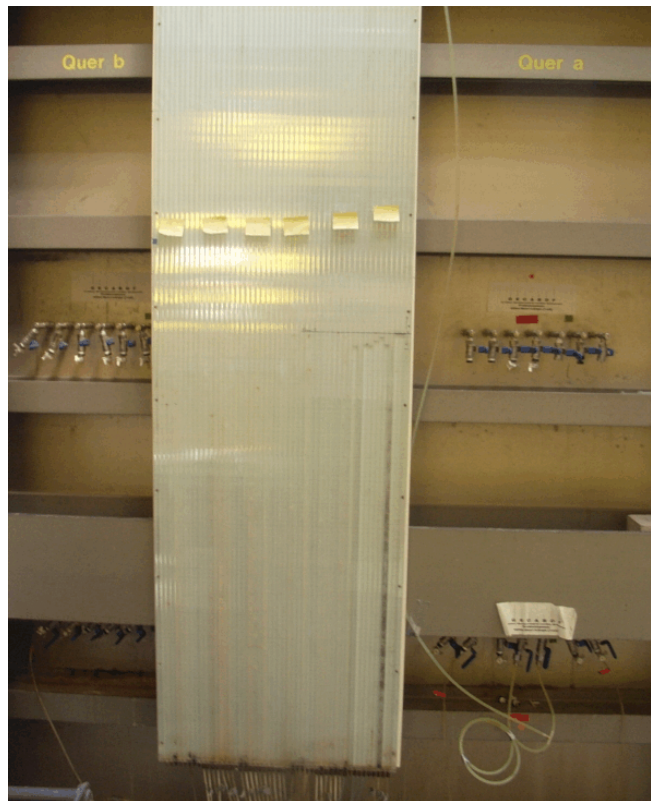
Abb. 66: Piezometerharfen zur Erfassung der Druckhöhen
