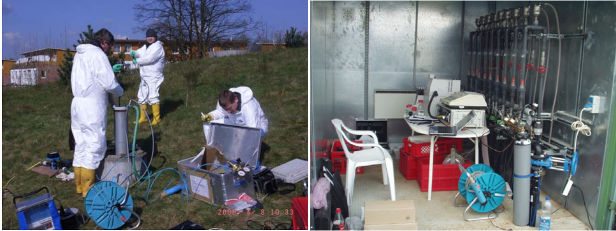
Abb. 34: Linkes Bild: Einsatz des CKW-Probennehmers, rechtes Bild: Messplatz GC-PID
