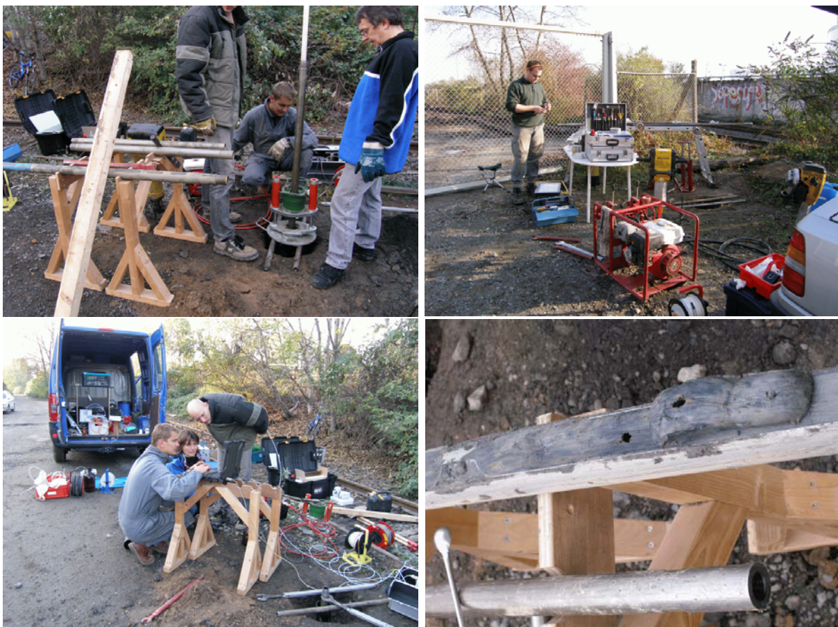
Abb. 57: Aufschlussarbeiten Standort bei Mainz (oben links: Sondierung mit VEGAS MOX-System, oben rechts: Sondierung mit in-situ GC Uni Hamburg-Harburg, unten links: Messbetrieb MOX-Sonde, unten rechts: Bodenprobennahme für Laboranalytik mit Aquifermaterial)
