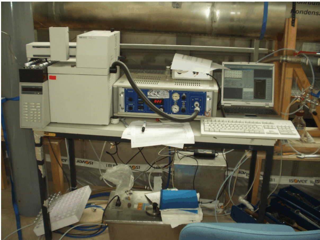
Abb. 14: GC-PID Messplatz mit Headspace-Autosampler (li) und Datenauswertung (re)
