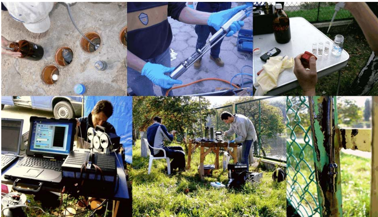
Abb. 26: Oben, von li. nach re.: Referenzprobenahme mittels Doppelventil-Pumpe (imw) und VEGAS Probennehmer und Probenvorbereitung. Unten, von li. nach re.: Fluoreszenz-Messungen in 1" Brunnen und vorhandenen 2"-Messstellen, sowie mit Teerölphase verklebter Faserkopf nach der Messung in G15
