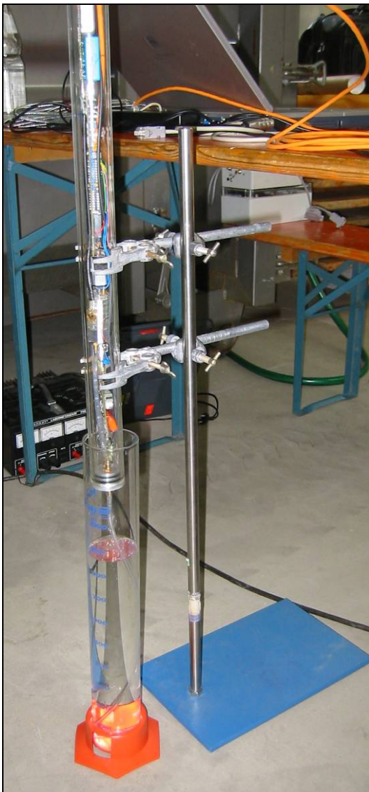
Abbildung 8: PAK-Fluorometer: Miniaturisierter Aufbau
