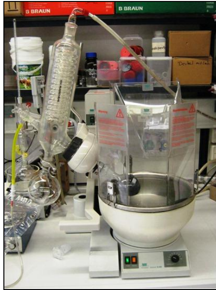
Abbildung 18: Rotationsverdampfer zum Trocknen der Eisen-Suspension, die Belüftung erfolgt mit Argon über eine Verbindung zu einem Argon-Gassack (gelben Schlauch links).
