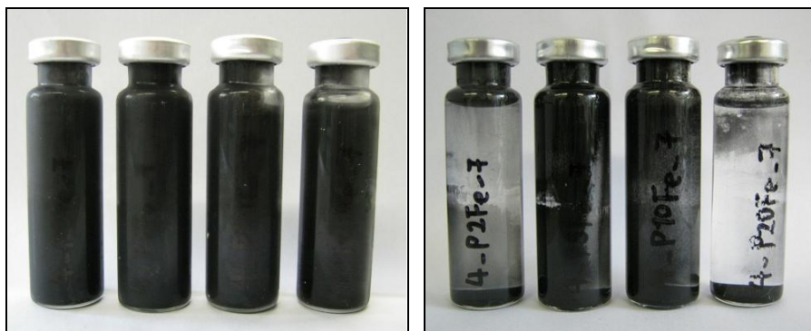
Abbildung 20: Darstellung der Versuchsproben von Testprodukt 4 (NAPASAN Partikel) am Tag 7 vor (links) und nach (rechts) Zentrifugieren.
