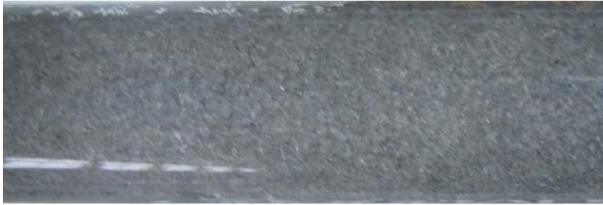
Abbildung 6.11: Säule DSW beim ersten Versuchslauf nach 35 Tagen Durchströmung, am oberen Bildrand sind Wasserstoffbläschen erkennbar
