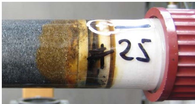
Abbildung 6.12: Rostbildung am Einlauf der Säule DSW beim ersten Versuchslauf nach 35 Tagen Durchströmung
