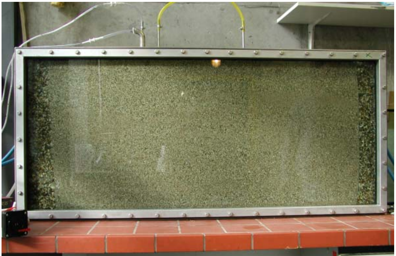
Abbildung. 2: 2-D Küvette zur Visualisierung der Strömungs- und Transportvorgänge bei Einsatz unterschiedlicher Injektionssysteme
