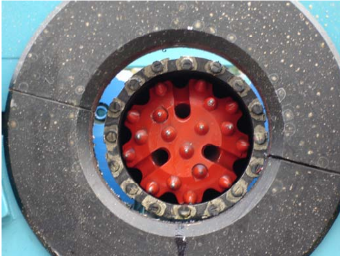
Abbildung 5 Ringbohrkrone und Imlochhammerbit
