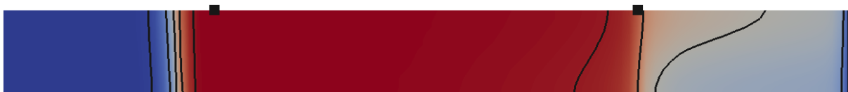
Abbildung 2: Stationäres Temperaturfeld für das Basisszenario, Querschnitt. Konturlinien bei 12.1, 13, 14, 15, 15.9 °C. Injektions- und Entnahmeklöcher sind als schwarze Quadrate gekennzeichnet.
