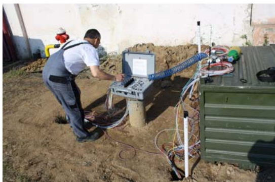
Spolchemie pilot site I, micropumps check (VEGAS/USTUTT)
