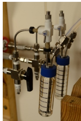
Abbildung: Gasfalle zur Wasserstoff-Bilanzierung
