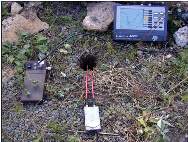
Abbildung 7: NAPL-Detektor im Feldeinsatz
