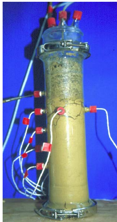
Abb. 5.8: Schwindungsrisse im Quellton infolge der Erwärmung
