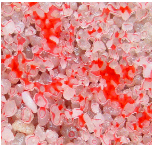
Abb. 3.14: Schadstoffverteilung im Porenraum eines Grobsandes für zwei unterschiedliche Systemtemperaturen von a) T = 20^{\circ}\text{C} und b) T = 70^{\circ}\text{C}
