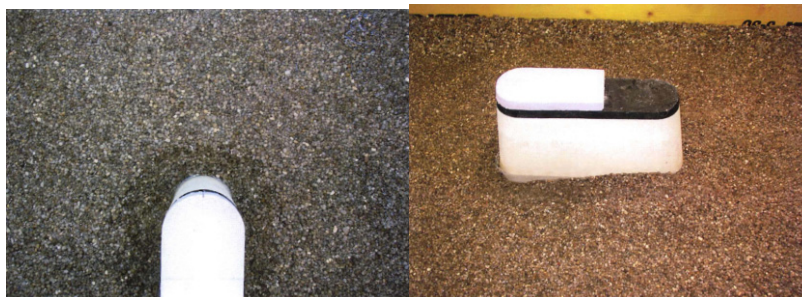
Abb. 19.2: Pfeilerkolk nach Versuchsdurchführung [3]
