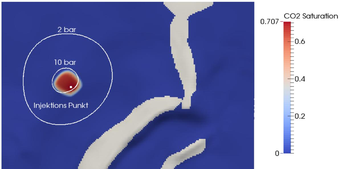
Abbildung II.12: Blick auf die Oberfläche der Injektionsschicht Solling. Zu sehen ist die Ausbreitung des CO<sub>2</sub> nach 50 Jahren Injektion, sowie zwei Isobaren. Der Salzstock ist in grau dargestellt. Die Injektionsrate beträgt 0.5 MT CO<sub>2</sub> pro Jahr.
