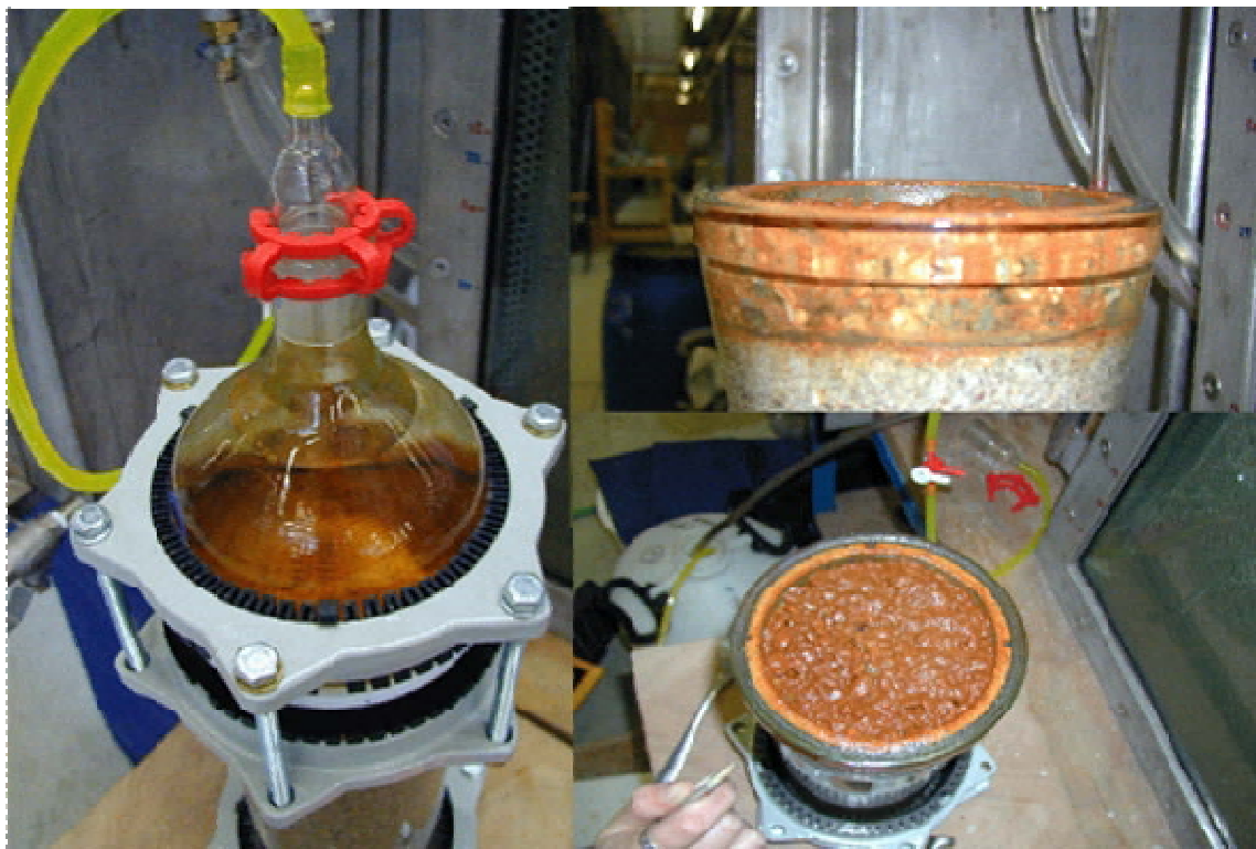
Abb. 18.5: Visualisierung der Eindringtiefe von Kolloiden im Säulenversuch
