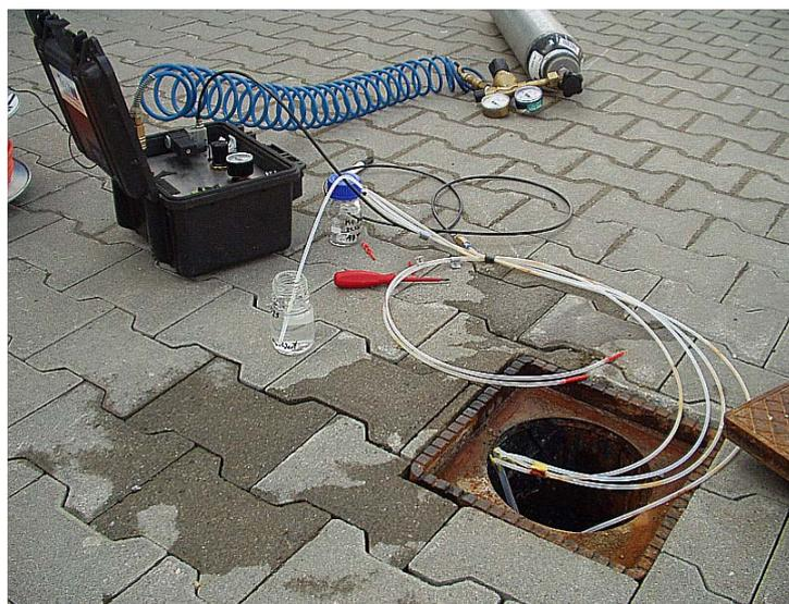
Probennahme mittels Minidruckpumpen
