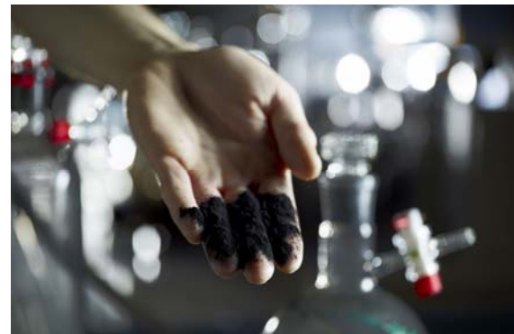
Carbo-Iron: Kombination von Nano-Eisen- und Aktivkohlepartikel – eine Entwicklung des UFZ. (Foto: Künzelmann / Helmholtz-Zentrum für Umweltforschung UFZ)
