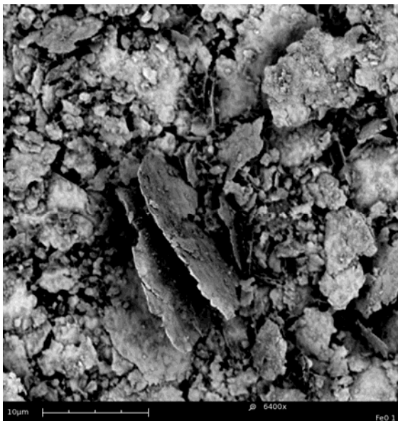
Bei der UVR-FIA GmbH gemahltes Eisen (nZVI). (Foto: UVR-FIA)
