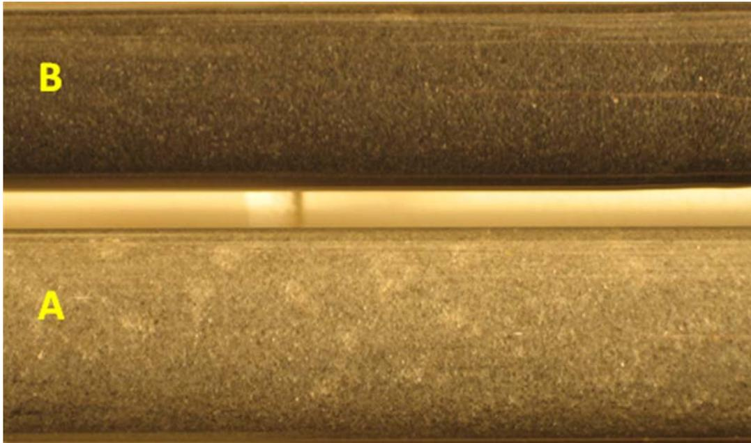
**Abbildung 13: Säule A ohne, Säule B mit pH-Kontrolle nach 6 Tagen Durchströmung**
