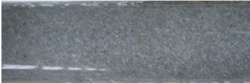
**Abbildung 11: Säule DSW beim ersten Versuchslauf nach 35 Tagen Durchströmung, am oberen Bildrand sind Wasserstoffbläschen erkennbar**
