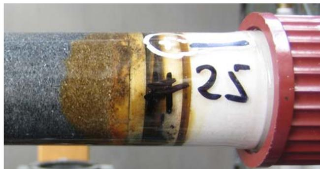
**Abbildung 12: Korrosionsprodukte am Einlauf der Säule DSW beim ersten Versuchslauf nach 35 Tagen Durchströmung**
