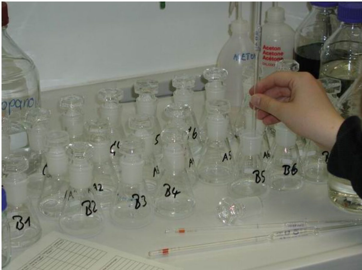
Abb. 2: Ansetzen von Alkohol-Wasser-Mischungen zur Bestimmung des Mischungsverhaltens
