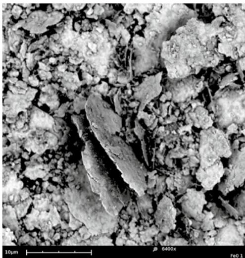
Abbildung 3: Bei der UVR-FIA GmbH gemahlenes Eisen (nZVI).
