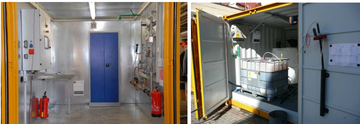
Abbildung 3: Mobile In-situ-Versuchsanlage zur raschen und sicheren Durchführung von ISCO-Pilotversuchen.
