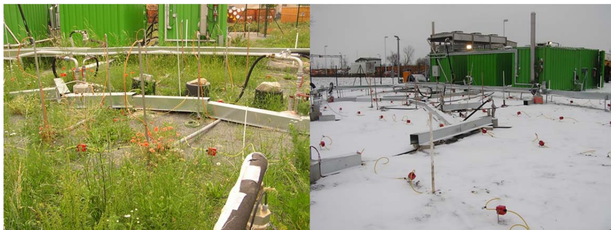
Abb. 4: Sanierungsfeld in Zeitz mit Injektions- und Extraktionsbrunnen und den technischen Anlagen 3 x 20“-Container (MOSAM) und den Einrichtungen fürs Temperaturmonitoring (rote Kästchen)
