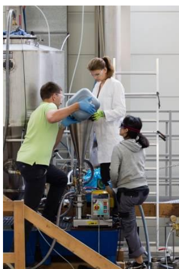
Abb. 4: Vorbereitung der Suspension (10 g/L NANOFER STAR and 5 g/L Carboxymethylcellulosen) für die Injektion in die große Rinne bei VEGAS (Foto: © VEGAS, Universität Stuttgart)
