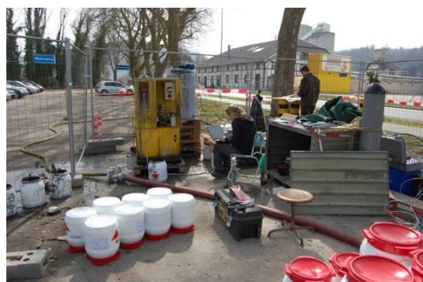
Abb. 5: Injektion von FerMEG12 (nullwertiges nanoskaliges Eisen) (Foto: © VEGAS, Universität Stuttgart)
