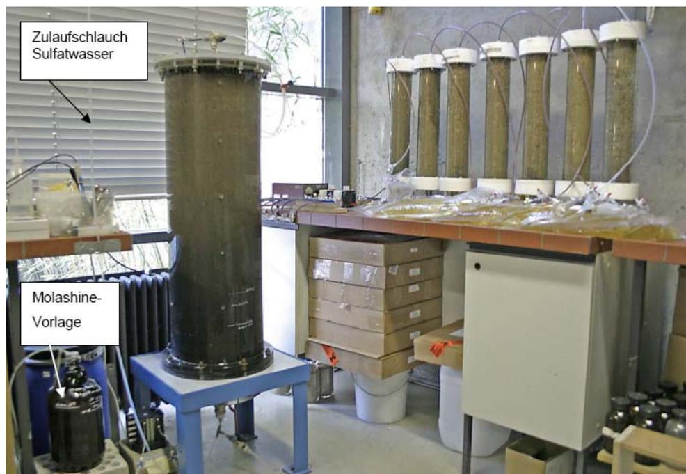
Abb. 5-4 Säulenaufbau und gesamter Versuchsstand
