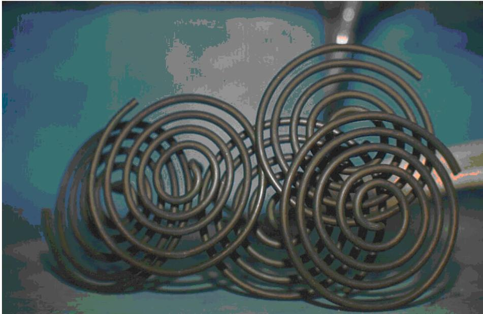
Abb. 2.3: Hochleistungs-Rohrpatronen als Heizelemente für eindimensionale Säulenversuche
