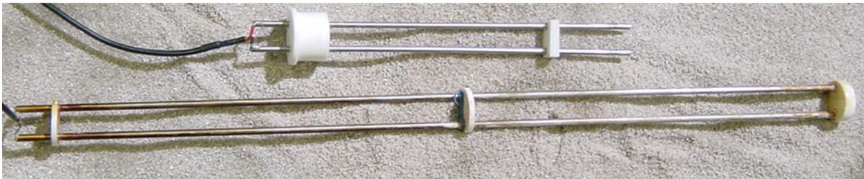
Abb. 4: Prototypen der Zweistab-TDR-Sonden zur Bestimmung der Wassersättigung
