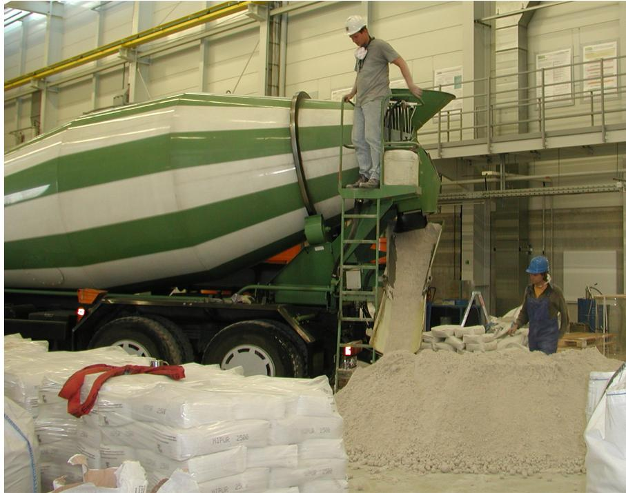
Abb. 6: Herstellung des Feinsand-Quarzmehl-Gemisches in einem Transportbetonmischer
