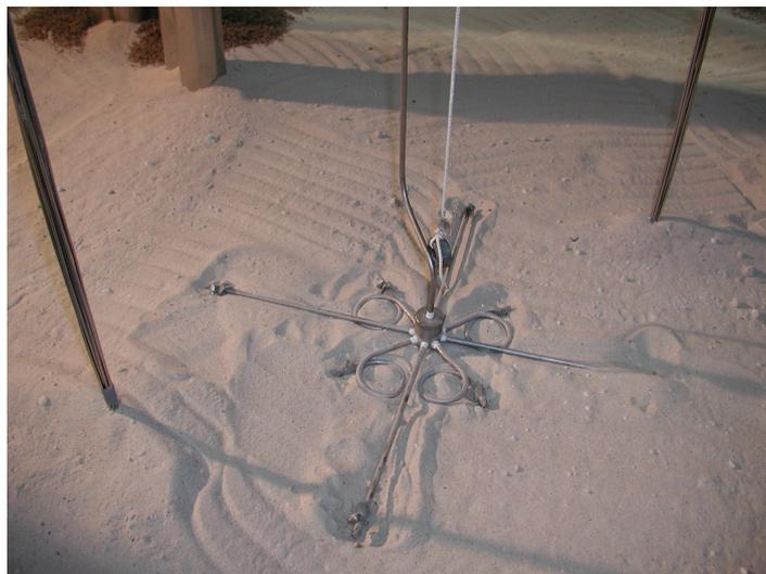
Abb. 12: Schadstoffdiffusor beim Einbau auf die gering durchlässige Schicht
