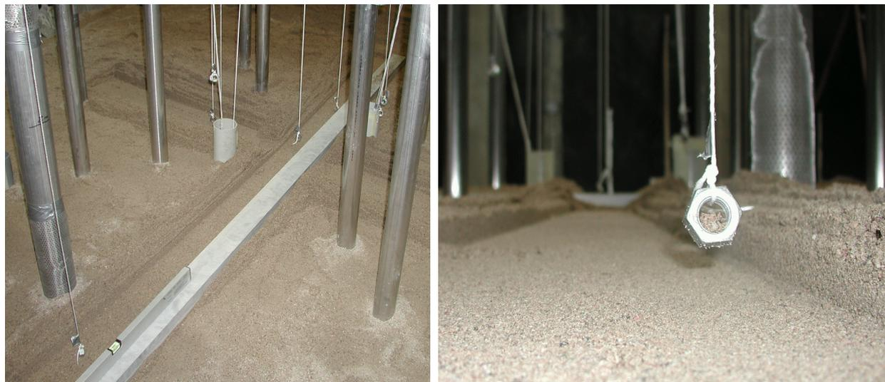
Abb. 10: Profilierung der Achsen zum Einbau der Pt100-Temperaturfühler
