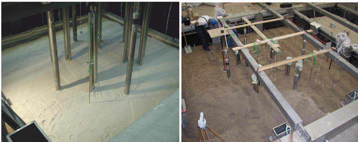
Abb. 9: Einbauzustand bei Erreichen der Feinschicht (links) bzw. knapp unterhalb der Endhöhe (rechts)
