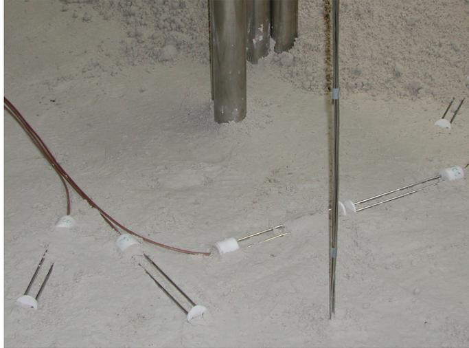
Abb. 11: TDR-Sonden beim Einbau, rechts vertikales Thermoelementprofil
