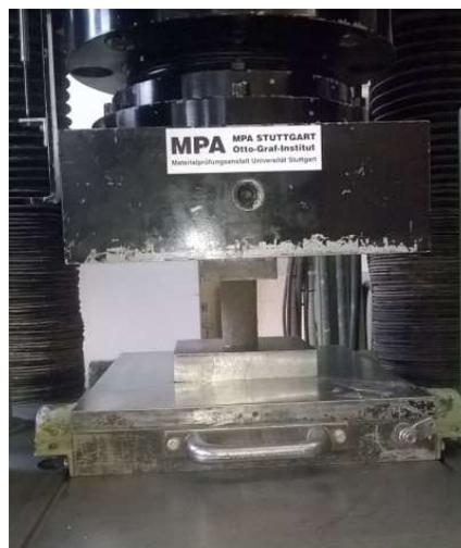
Abbildung 56: Prüfung der einaxialen Druckfestigkeit
