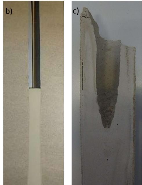
Abbildung 54: a) Versuch Bohrlochverfüllung, b) Ziehen der Verrohrung, c) Ausgebauter Verfüllkörper
