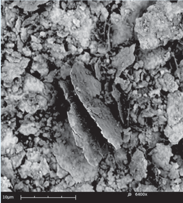
Bei der UVR-FIA GmbH gemahlenes Eisen (nZVI)
