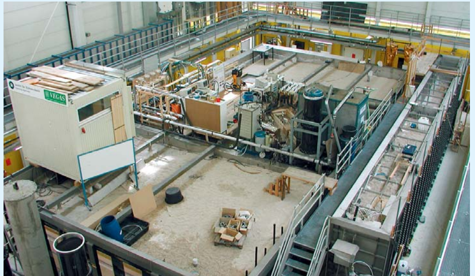
GROSSSKALIGE EXPERIMENTE BEI VEGAS: Mit Sand gefüllte Großcontainer (18 x 6 x 4.5 m), in denen definierte Schadstoffquellen mit Hilfe von Nanopartikeln saniert werden.
