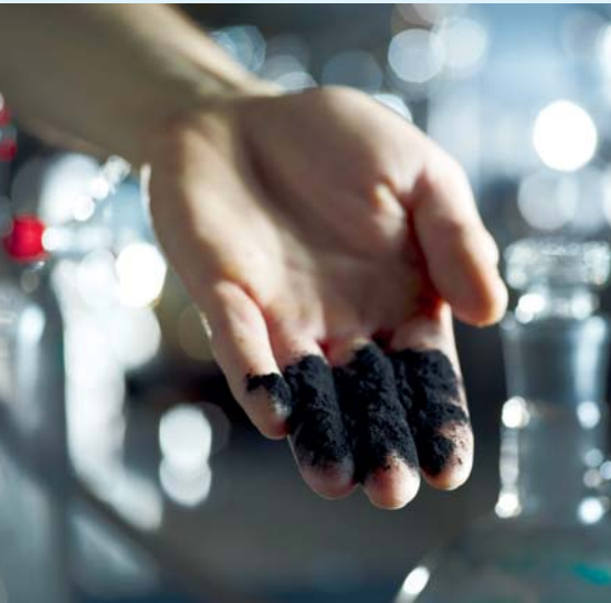
CARBO-IRON: Eine vom UFZ Leipzig entwickelte Kombination von Nano-Eisen- und Aktivkohlepartikel Foto: Künzelmann/UFZ
