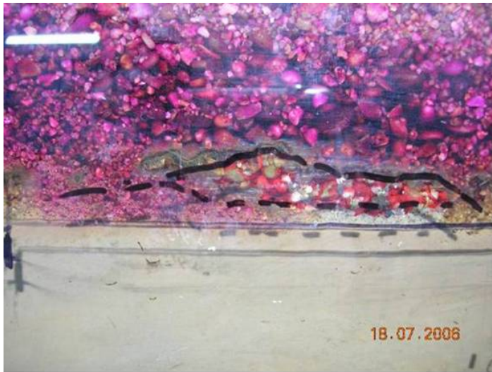
Abbildung 63 – Braunsteinbildung um CKW-Pool, Detail, Küvette
