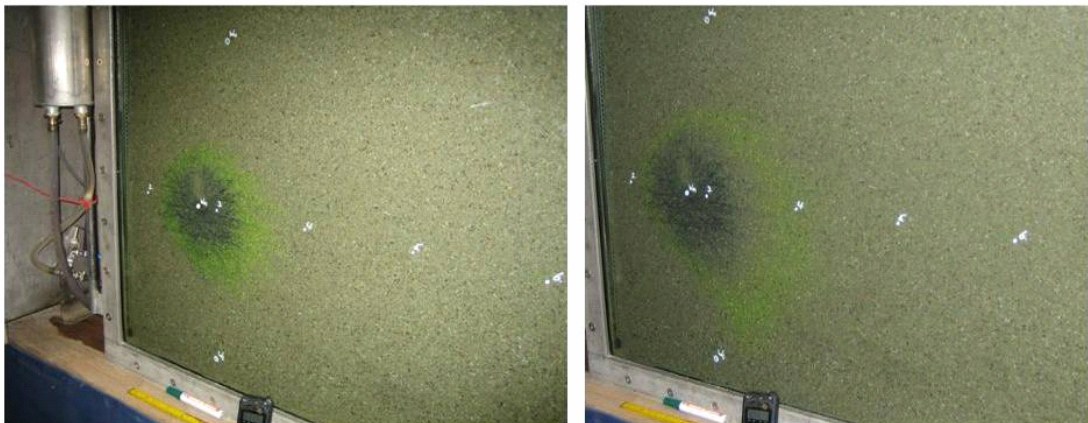
Abb. 7.2: Ausbreitung einer Nano-Eisen-Suspension und eines konservativen Tracers
