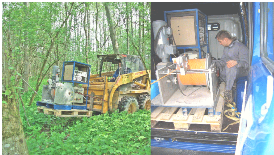
Abb. 10.5: Erster Testaufbau der Winde zum Ablassen der Sonde im Feldeinsatz
