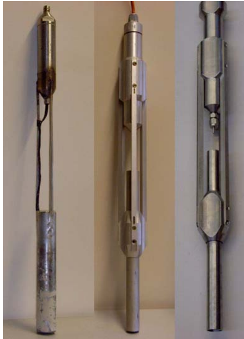
Abb. 10.6: Entwicklungsstadien der Thermoflow - Sonde vom ersten Prototyp bis zur Vorserie (von links nach rechts)
