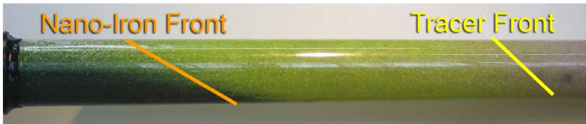
Abb. 7.5: Retardation beim Transport von Nano-Eisen
