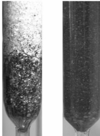
Abb. 8.1: Mobilität von Carbo-Iron beim Durchfließen von Aquifermaterial (0,25 - 1 mm).
