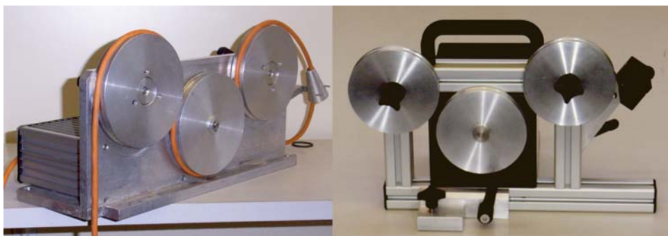
Abb. 10.7: Entwicklungsstadien der Winde. Der erste Prototyp ist in Abb. 10.5 zu sehen.
