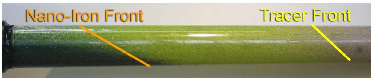
**Abb. 10.3: Erhebliche Retardation beim Transport von Nano-Eisen.**
