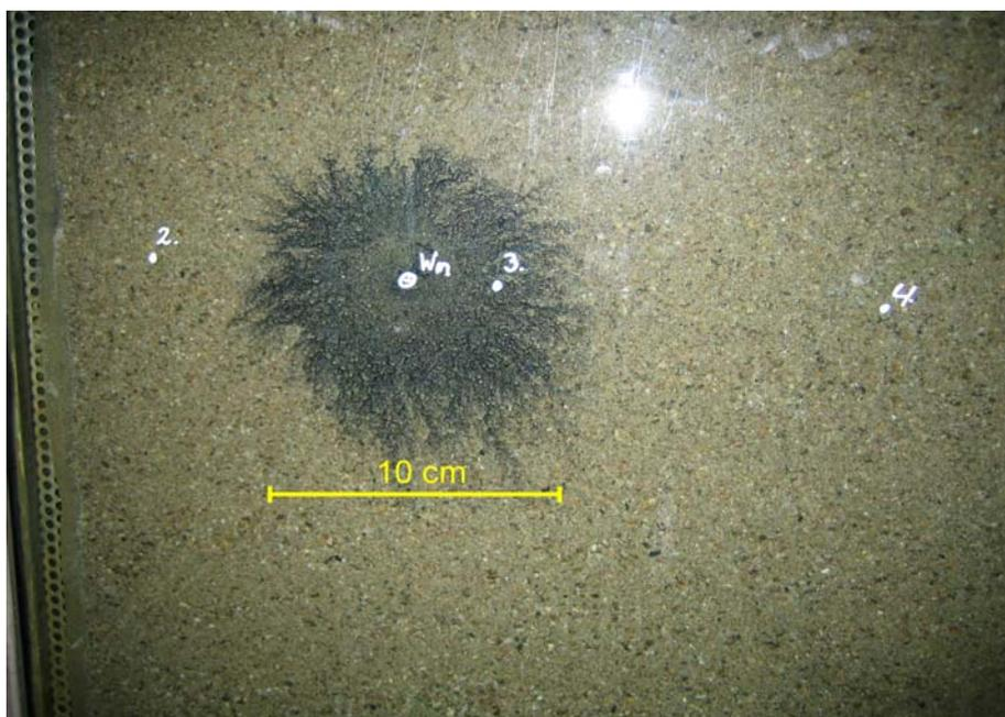
Abb. 10.2: Nano-Eisen Injizierung: maximale Ausbreitung nach 5 Minuten erreicht
