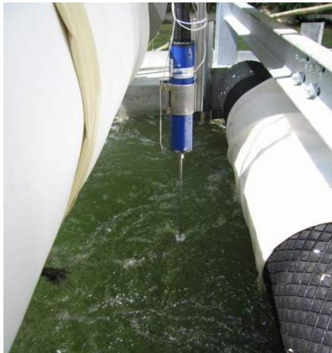
Bild 7: 3d-Geschwindigkeitssonde (hier: Acoustic Doppler Velocimeter, ADCP)
