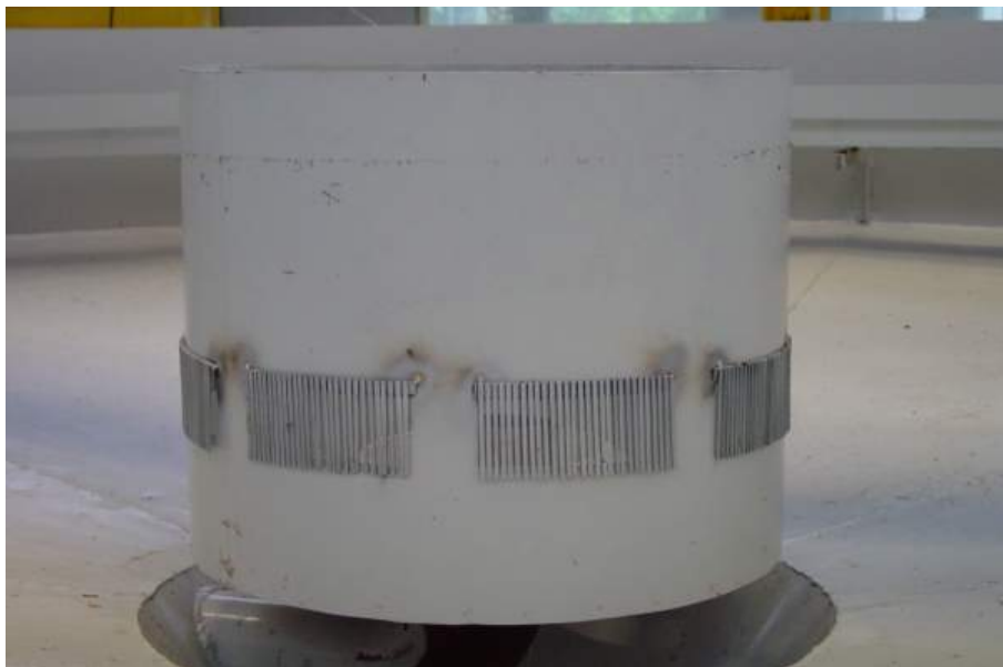
Bild 10: Ist-Zustand des Zulaufbauwerks mit Gittern an den Zulauföffnungen (V0)
