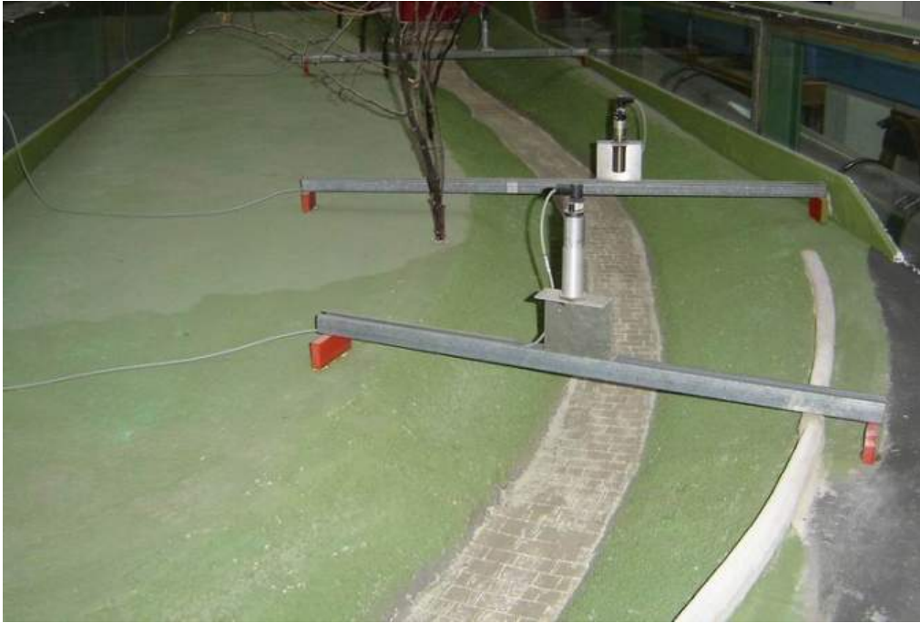
Bild 6: Ultraschallsensoren zur berührungslosen Bestimmung von Wasserspiegellagen
