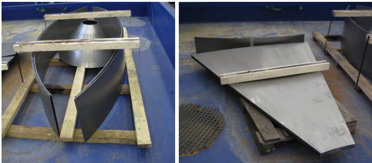
Bild 2: Einzelformteile für den Aufbau des Nachklärbeckens im Modell
